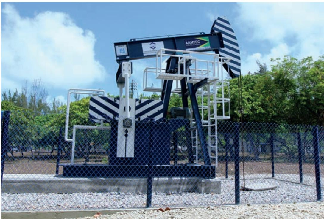
Equipamento de bombeio mecânico C-114 (Terra). Altura máxima: 5,5m; largura: 2,7m; comprimento: 5,5m.
